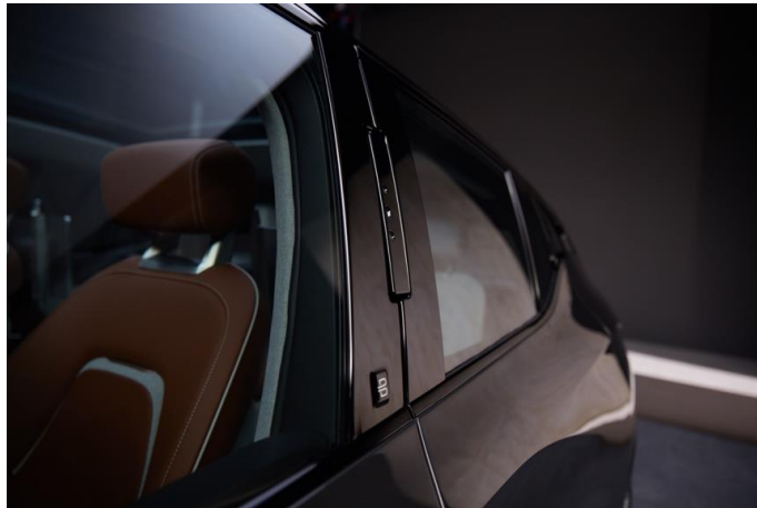
(BYTON 概念车的脸部识别摄像头精致地嵌在 B 柱上)
